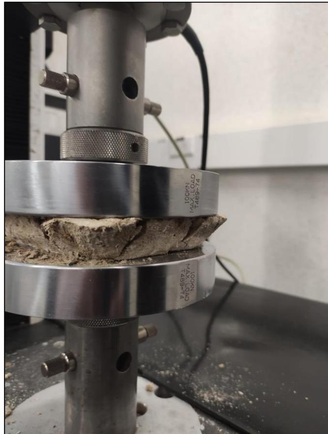
*Ilustración 35 Rupturas del concreto en su esfuerzo máximo (finalización ensayo)*
