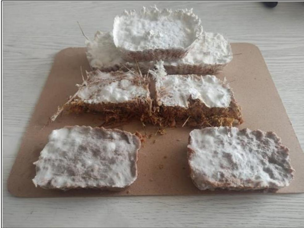
*Ilustración 22 ladrillos de micelio con sustrato, finalización observación*
