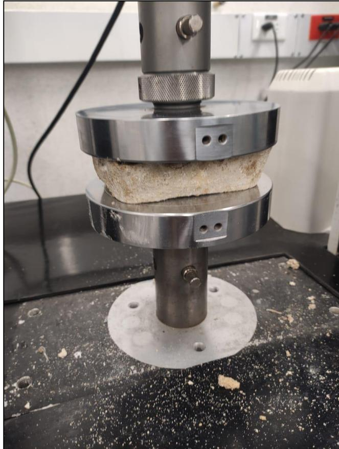
*Ilustración 34 Ladrillo de micelio con concreto en la prensa*
