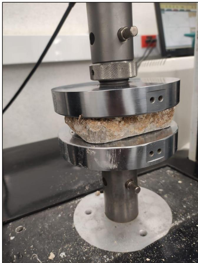
*Ilustración 31 Ladrillo de micelio con cemento y agua en la prensa*
