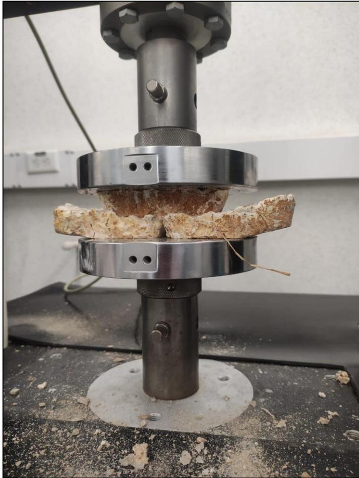
*Ilustración 38 Ladrillos de micelio con sustrato en prensa deformados (finalización)*
