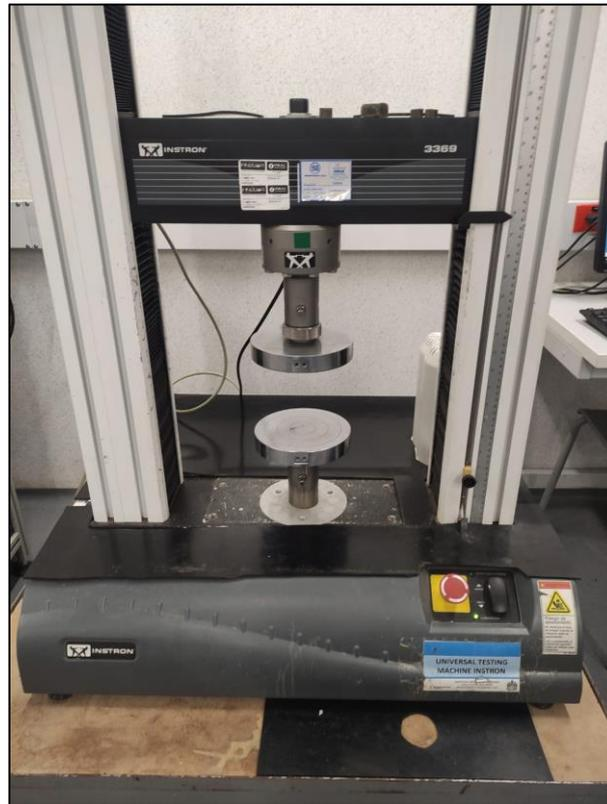
*Ilustración 24 Modelo de prensa de compresión Instron 3369*
