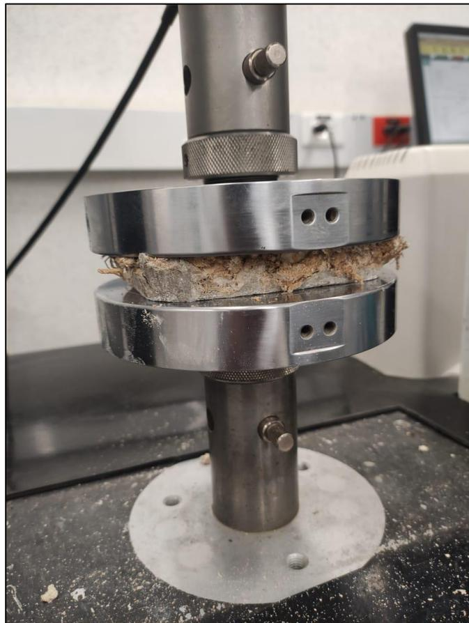
*Ilustración 32 Deformación prototipo durante ensayo (finalización)*
