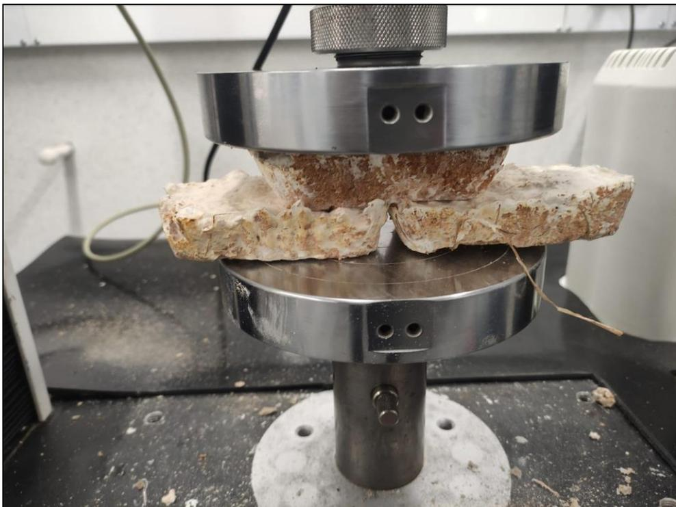
*Ilustración 37 Ladrillos de micelio con sustrato en prensa*
